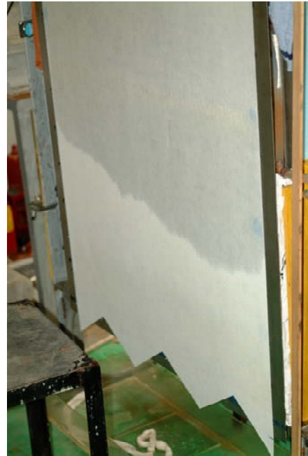
図7 海水が浸透・流下しているウィック
