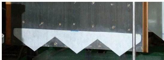
(b) 背面に貼付けられた凝縮水回収ウィック
