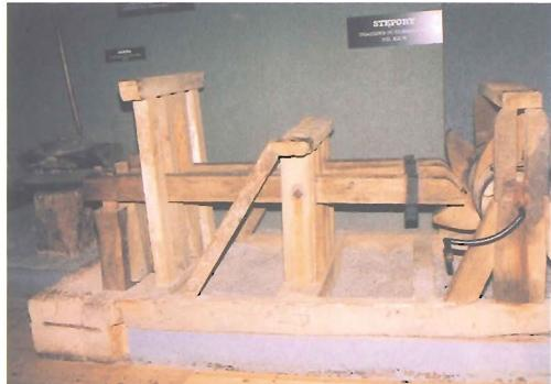
写真-14 岩塩粉碎器：右側のホイールを回して左側の木槌で砕く
