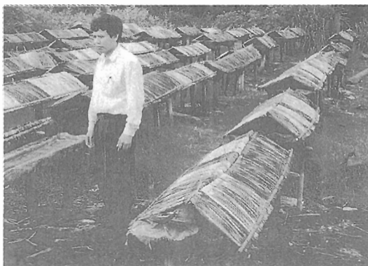
椰子の幹で作った塩精製の仕掛けと椰子の葉を編んだ屋根。側に立つデワ・スプラブタ博士
