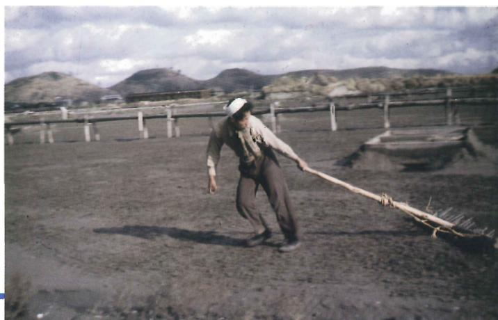
起こし浜　－雨で叩かれて地盤に密着した撒砂を搔き起こす作業－　（大塩的形浜）
