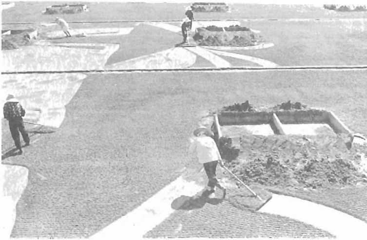
浜持ち—塩分の付着した砂を集め、 沼井（ぬい）に入れる。
