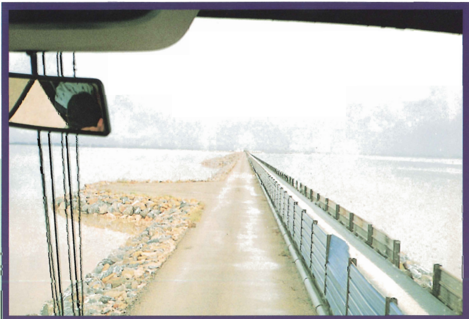
集塩場から陸上の洗塩施設まで約1,500mのコンベアで運ばれる (トレビエハ塩田)
