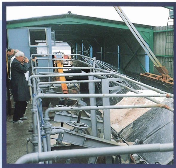
集塩場 バージを反転し塩をコンベアに送る (トレビエハ塩田)
