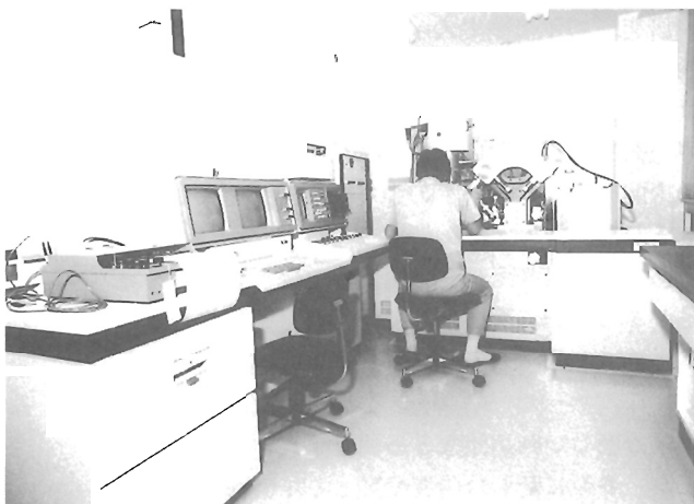
二次イオン質量分析装置（SIMS） 全元素分析に迅速に対応できる最新機器。
