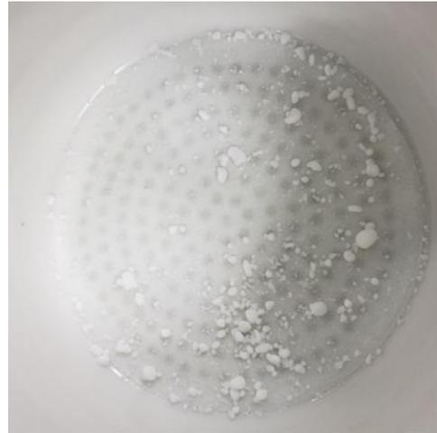
図 13 沈殿剤に  $\text{Ca}(\text{OH})_2$  を用いた場合の結晶
