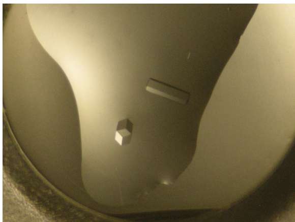
図 7 LNX3-PDZ1 + CLDN16 C 末端ペプチド複合体の結晶
