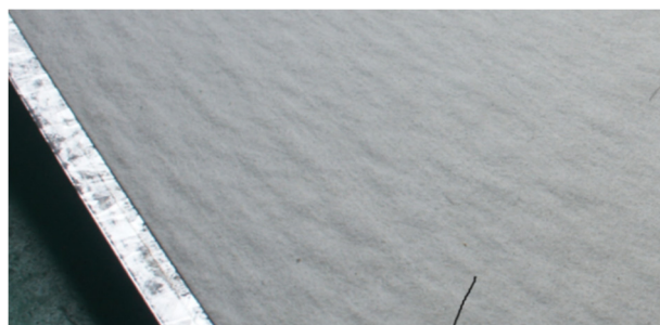
Fig.11 金属板との間に多数の空気泡が形成された蒸発ウィックの写真
