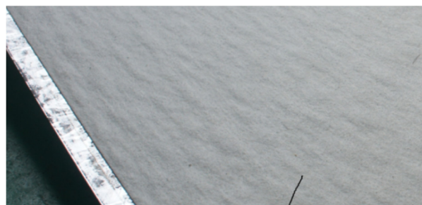
Fig. 14. 平板との界面に気泡が形成された蒸発ウイック
