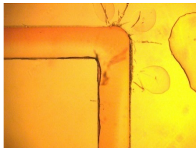
図3. 屈曲部を有するマイクロ流路の観察結果(左上:合流部, 右上:1 番目のベンド, 左下:2 番目のベンド, 右下:3 番目のベンド, 流量は各流体とも 1 mL/min)
