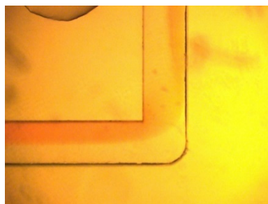
図2. T字型マイクロ流路の合流部の観察結果(左:流量各 4 mL/min, 右:流量各 5 mL/min)
