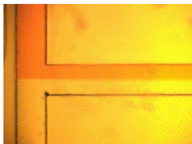
図2. T字型マイクロ流路の合流部の観察結果(左:流量各 4 mL/min, 右:流量各 5 mL/min)
