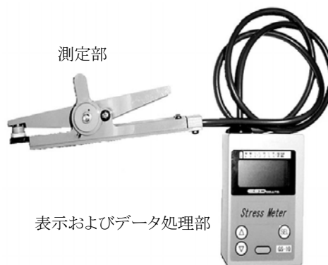
図 4. 植物ストレスセンサーの試作機
