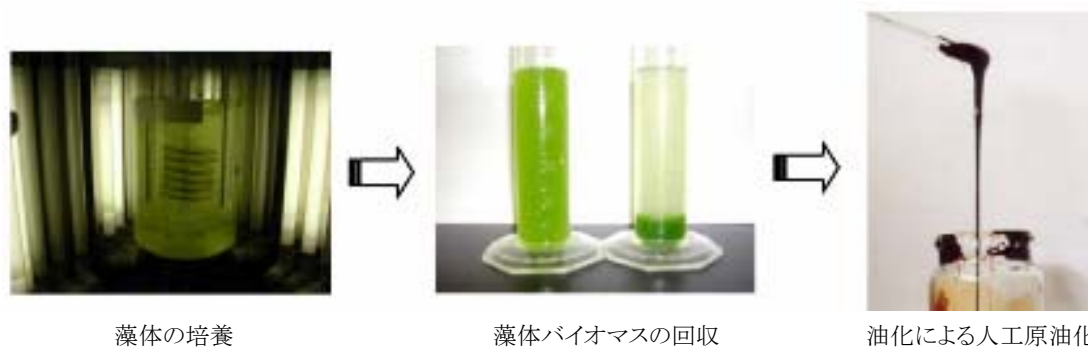
Fig. 11 耐塩性藻類を用いた人工原油生産プロセス
